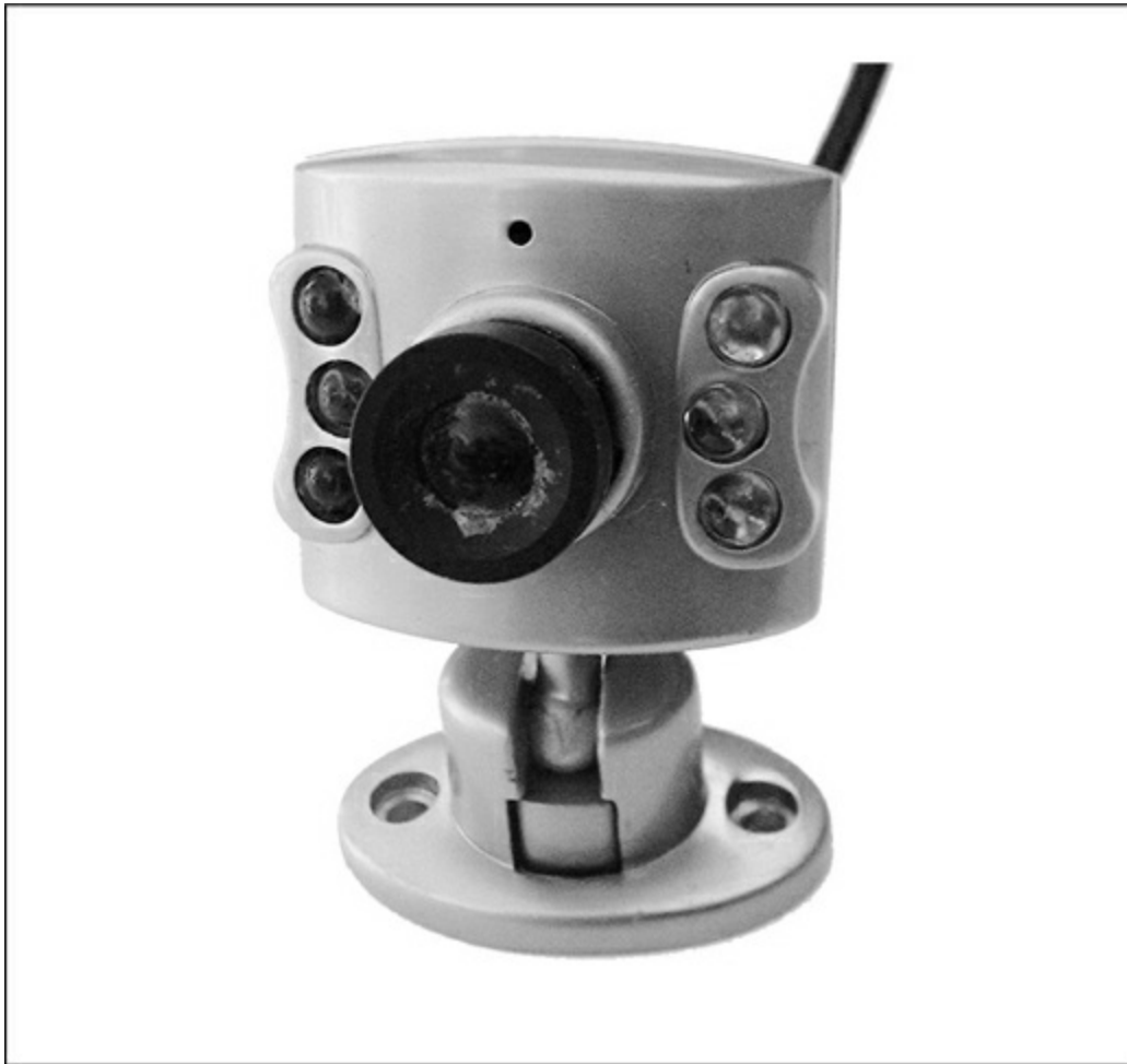
Figura 15.7 Questa videocamera in miniatura è in grado di vedere nel buio, grazie ai suoi sei LED a infrarossi (IR LED).
