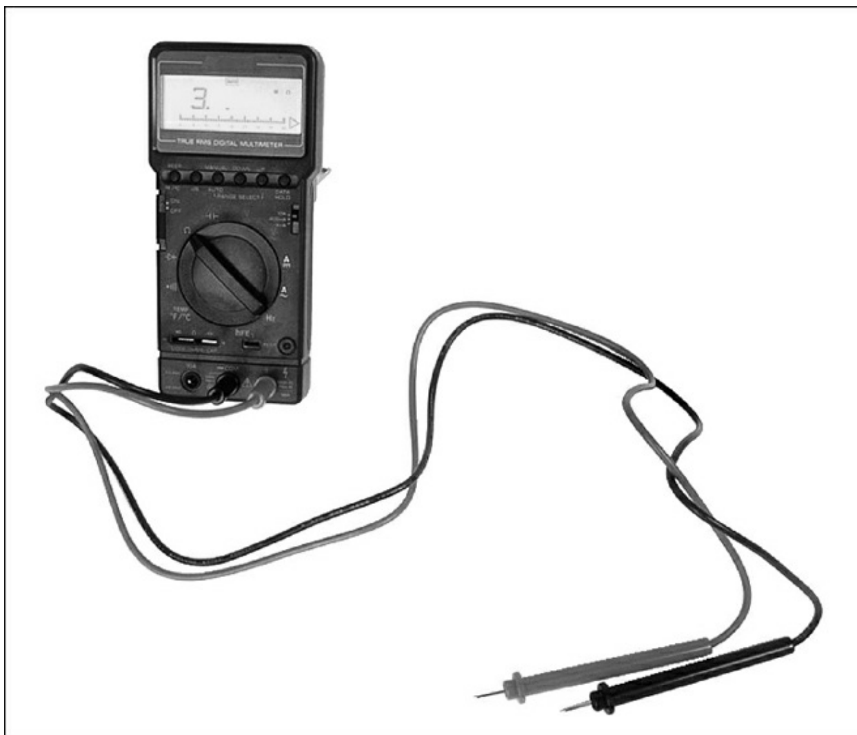
Figura 12.1 I multimetri misurano la tensione, la resistenza, la corrente e la continuità.
