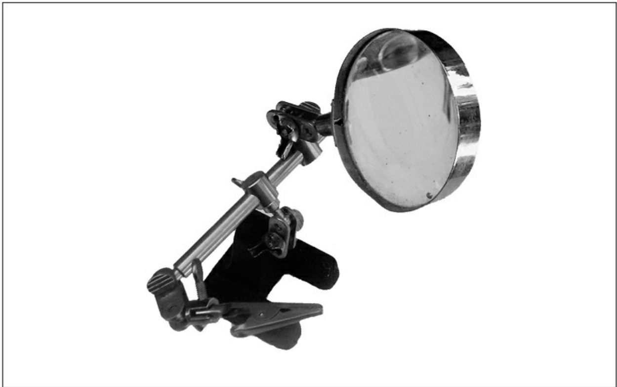
Figura 9.4 La “terza mano” è dotata di una o più pinzette e, a volte, di una lente d'ingrandimento.
