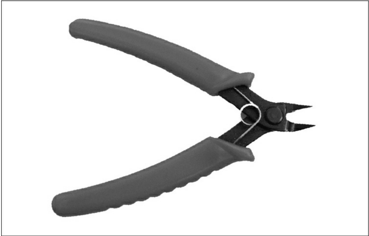
Figura 9.3 Un tronchesino specifico per elettronica evita che la parte eliminata salti chissà dove.
