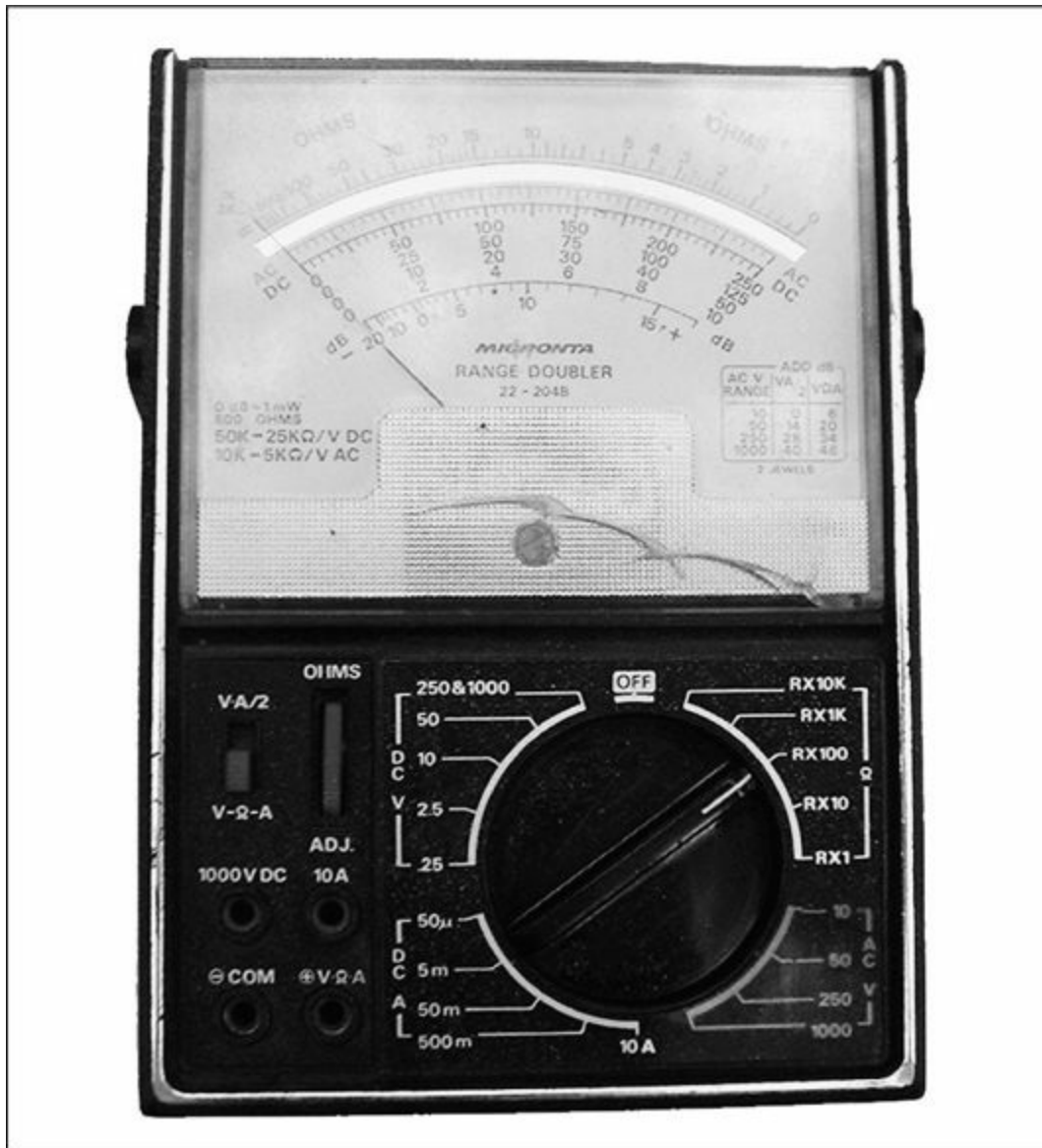
Figura 12.2 Un multimetro analogico usa un ago per indicare la tensione, la corrente e altri valori.
