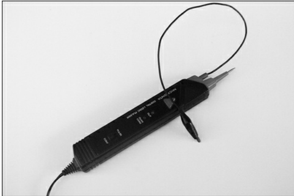
Figura 16.3 Un logic pulser può inviare a un circuito un unico impulso o un treno di impulsi.
